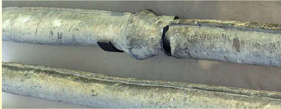
Tubo de agua romano, hecho de tiras de plomo soldadas (Museo de Arles y la antigua Provenza)
